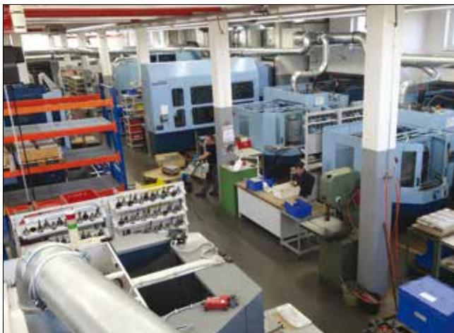
L'atelier des machines se trouve au frais dans le sous-sol et dispose ainsi naturellement d'une température de base stable. Une condition idéale pour une précision maximum.
