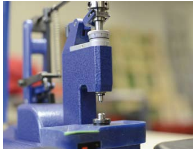
L'appareil à riveter d'Animex est installé dans de très nombreuses manufactures horlogères. Sa robustesse et sa régularité en sont les avantages les plus appréciés.
