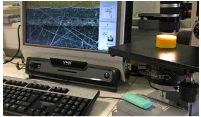
Microscope et équipement d'évaluation pour examens métallographiques.
