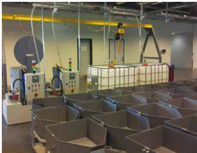
Essoreuse Aryma pour le déshuilage des copeaux et des pièces.
