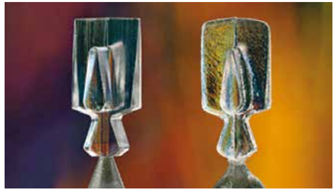
Différences majeures de résultats de qualité et de précision de forme entre l'enfonçage EDM et le Micro Fraisage 3D par Micro EDM.
