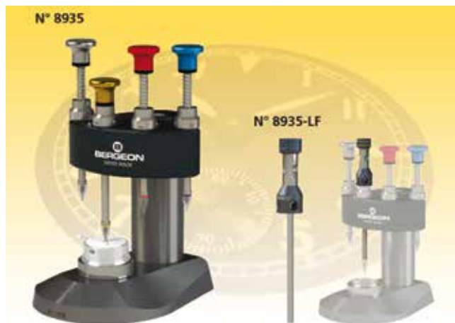
La potence à 4 broches pour poser les aiguilles, réf. 8935 est issue d'une fabrication interne et est réalisée comme suit: bâti en aluminium anodisé, broches en acier inoxydable trempé-revenu, accessoires en polycarbonate.
