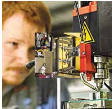
Broche rotative à haute précision avec avance et compensation d'usure automatique d'électrode.
