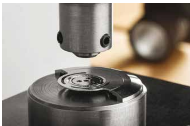
Exemple de montage d'un roulement miniature dans une masse oscillante.
