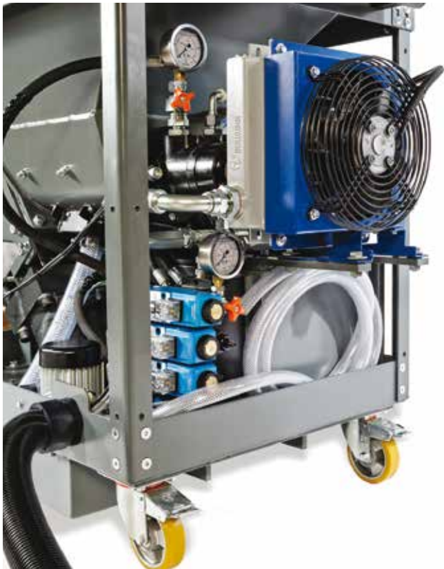
L'EVTM-55-L regroupe tous les composants mécaniques et hydrauliques à l'intérieur du châssis.
