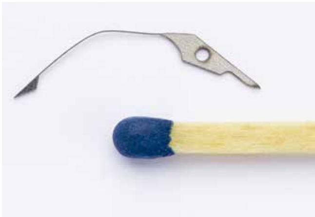
Elément (levier-ressort) pour un mécanisme horloger, découpé par Micro-Découpage AWJmm.
