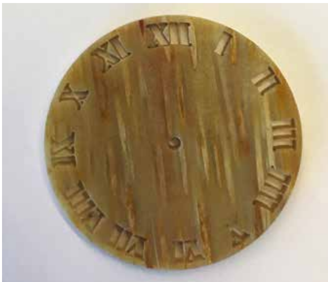
Découpe dans un cadran en bois pétrifié de 2 mm d'épaisseur. Le résultat est comparable à celui de l'érosion à fil.
