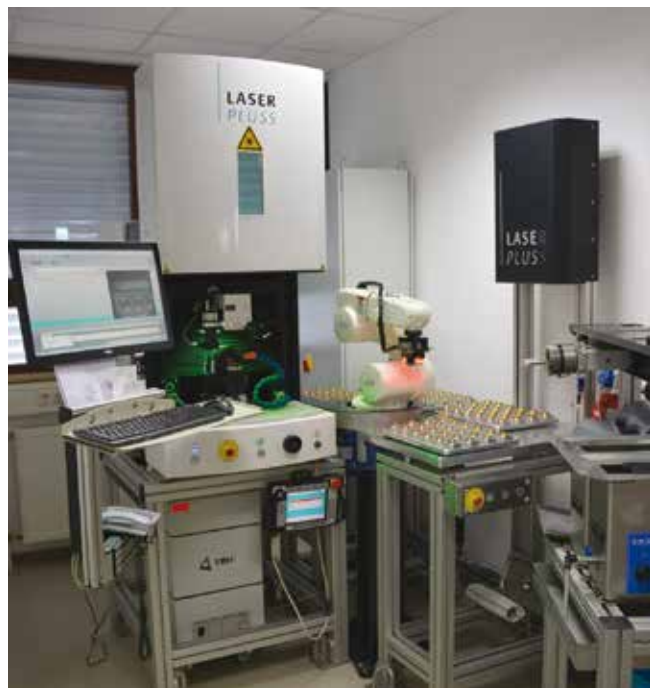
Depuis l'achat d'un système Laserpluss début 2016, RM Lifestyle grave des composants de montres en interne avec une grande fiabilité et une grande qualité. (Photo : F. Rossmann)
