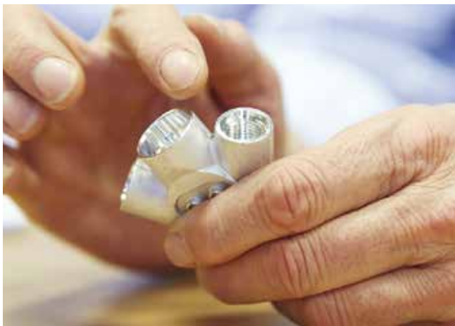
Une pièce brute forgée en un alliage d'aluminium spécial, contenant du silicium (AlSi05), fait office de matériau de base.
