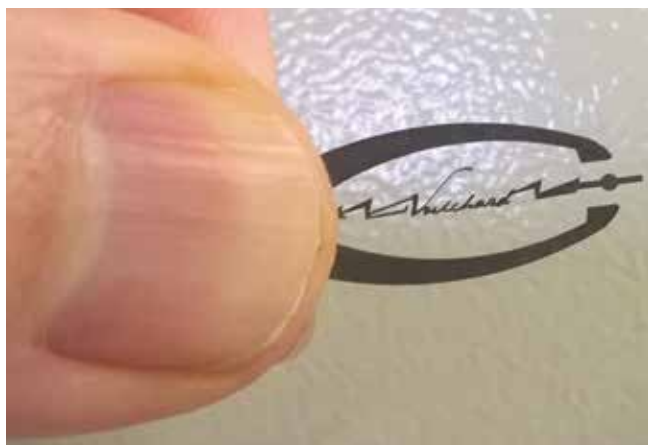
Découpe laser sur tous types de matériaux, ici dans de la céramique.
