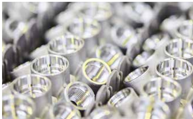
Précision de haut niveau: l'ouverture H7 constitue un bon exemple de précision, elle peut en effet être fraisée à 14 µm exactement.
