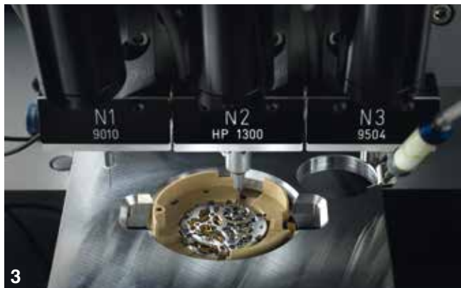
1. Informatisés et partiellement automatisés, les flux de production sont très faciles à modifier. 2. Tous les tests effectués – ici l'étanchéité – donnent lieu à une analyse de données, lesquelles sont recoupées avec les retours du SAV. 3. Certaines opérations – ici le huilage – sont automatisées, et donc font l'objet d'un contrôle permanent. 4. Tous les calibres circulent dans des barquettes, lesquelles disposent d'une puce RFID qui enregistre chaque étape de la fabrication et chaque caractéristique du mouvement.
