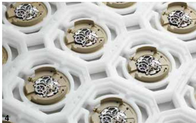
1. Informatisés et partiellement automatisés, les flux de production sont très faciles à modifier. 2. Tous les tests effectués – ici l'étanchéité – donnent lieu à une analyse de données, lesquelles sont recoupées avec les retours du SAV. 3. Certaines opérations – ici le huilage – sont automatisées, et donc font l'objet d'un contrôle permanent. 4. Tous les calibres circulent dans des barquettes, lesquelles disposent d'une puce RFID qui enregistre chaque étape de la fabrication et chaque caractéristique du mouvement.
