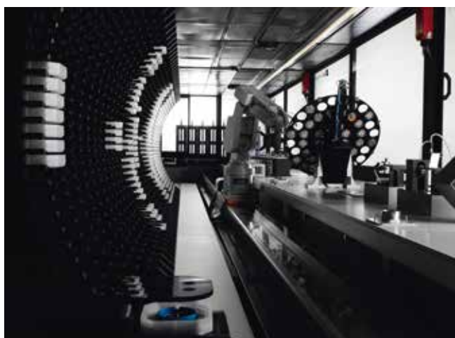
En fin de production, un bras robotisé effectue un contrôle de marche et associe le numéro de la puce RFID au numéro de la montre. Toutes les informations de construction sont ainsi liées au produit.
