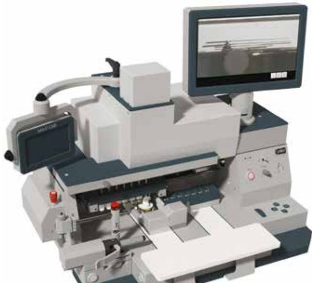
MAAI CN8: Machine de pose aiguille semi-automatique avec dispositif d'aide au réglage et de contrôle paragement.
