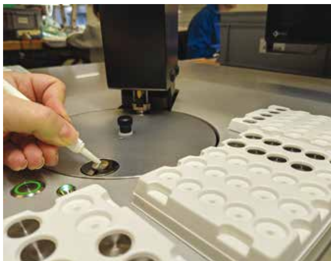
Pose du barillet.
