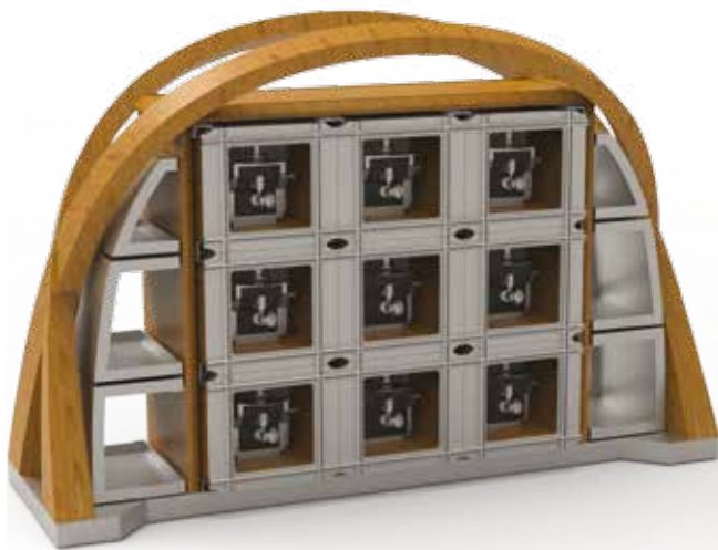
Solution d'avenir: la micro-usine autonome est reconfigurable et composée de diverses micromachines interconnectées.
