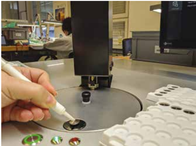
Mesure et correction de l'ébat à 100% par une machine semi-automatique développée par Petitpierre SA - une société du groupe Acrotec.
