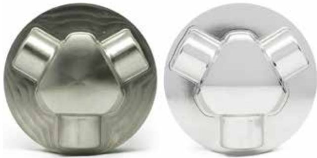
Articulation sphérique traitée via le procédé de polissage électrochimique à sec DLyte.
