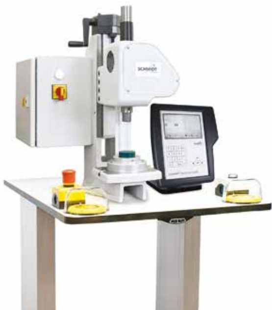
Presse électrique et bouton bi-manuels avec établi.
