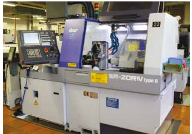
Grâce à leur construction à l'ancienne, avec notamment un châssis en fonte, les machines Star de la série SR font partie des machines les plus stables du marché.
