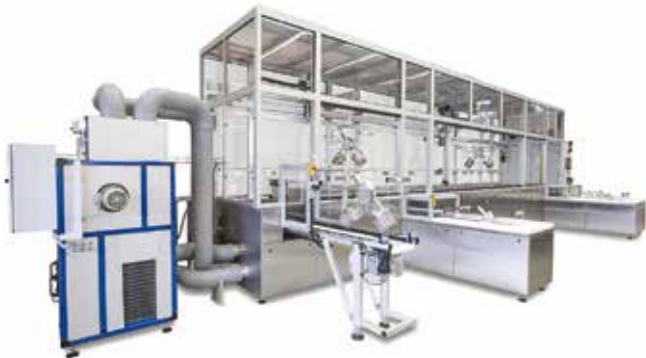
Système combiné avec nettoyage par ultrasons et séchage par condensation: durée de cycle de 6 minutes et température de séchage de 40 ° C
