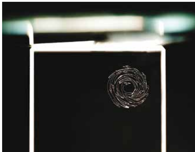
Graver avec un laser au centre de la matière. (@2021 EPFL Alain Herzog)
