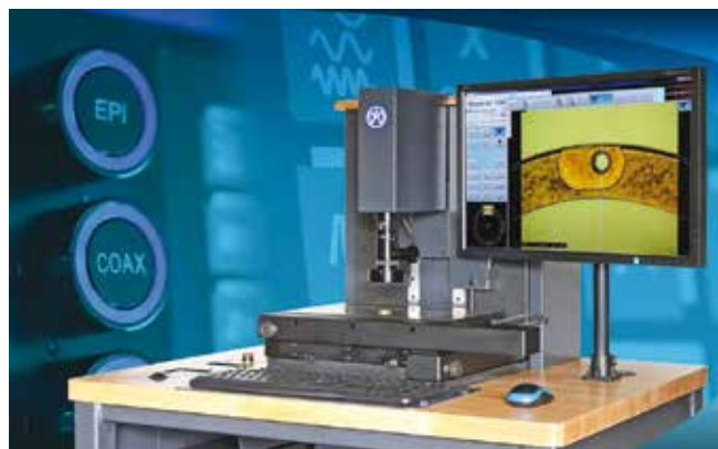
La machine Recto Verso permet de mesurer la face d'une pièce avec sa référence sur la face opposée.
