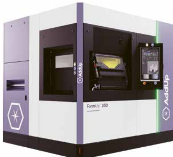
La machine FormUp 350 nouvelle génération peut utiliser de la poudre fine pour imprimer des pièces en 3D métallique. Elle est la solution pour relever les défis des industriels : sécurité, productivité, qualité et obsolescence.
