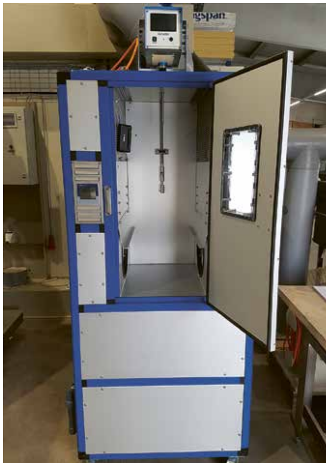
Séchoir de dimensions compactes pour l'horlogerie - une série spécifiquement conçue pour le séchage de pièces de très petites dimensions. La chambre de séchage peut accueillir soit des paniers, soit des supports de pièces.
