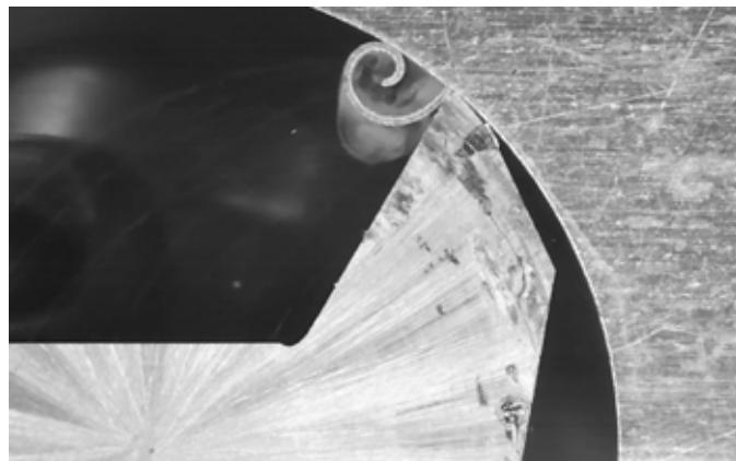
Le laiton sans plomb glisse sur la lame de scie et forme un mince copeau.
