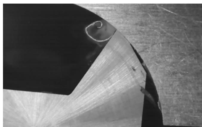
Dans l'usinage du titane, les températures les plus élevées sont atteintes à proximité de l'arête de coupe et dans le copeau. Cela se traduit par la formation d'un nuage brillant autour du copeau.
