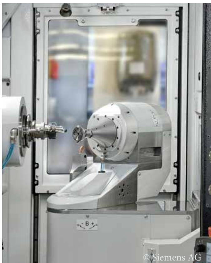
vorrichtung ermöglicht die Werkstückbearbeitung von oben und unten. Außerdem kann die C440-Maschine mit einem Drehmodul ausgerüstet werden. Wichtig: Fast alle Werkzeuge sind mit den Modellen C480, C400B, C400F und C400S kompatibel.
