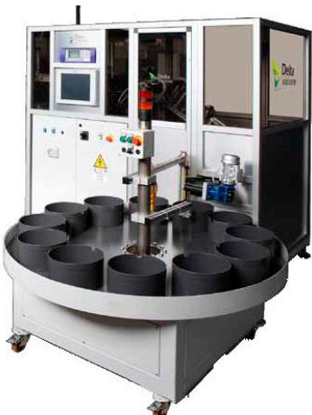
Machine de tri par laser.
