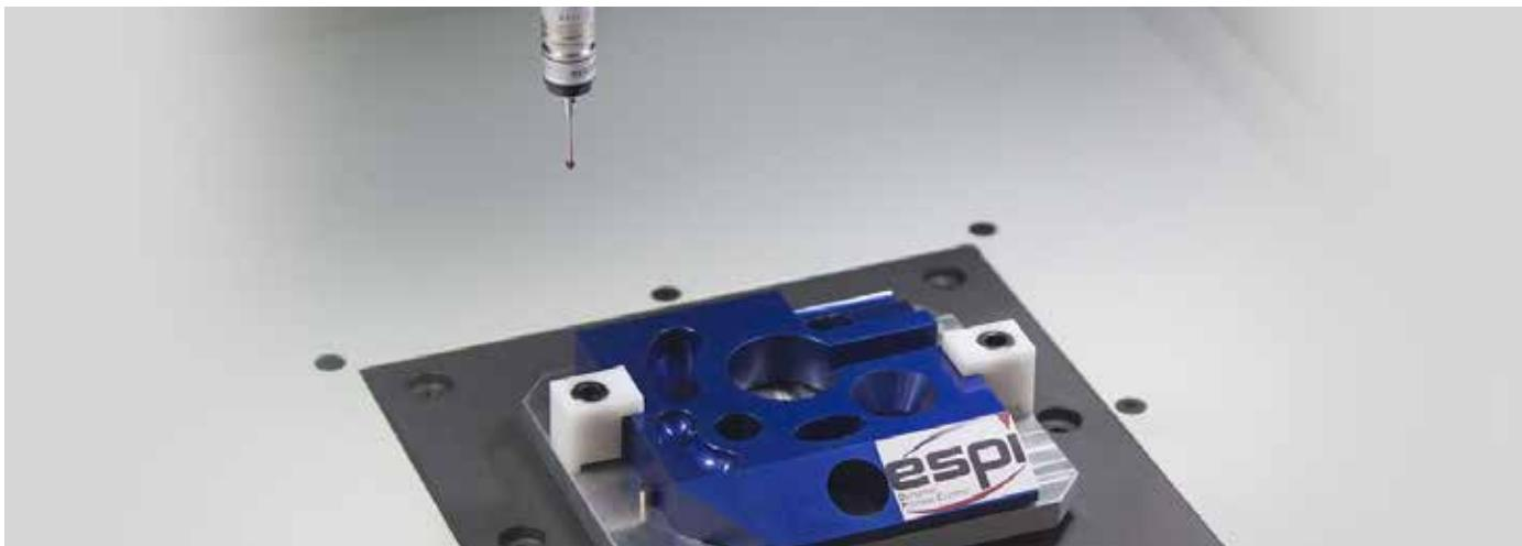
20 bis 80 % ausgesetzt werden. Sie bieten eine Präzision von +/- 0,2 bis 0,75 µm, eine Auflösung von 0,1 µm bei einer Abtastgeschwindigkeit von 8 bis 30 mm/s und eine Zyklusdauer von weniger als einer Sekunde pro Merkmal.
