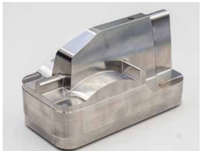
Fabrication additive d'un insert de moule poli à haute brillance.
