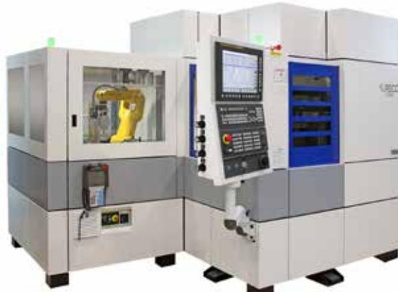
La nouvelle machine Recomatic CT501 avec une plateforme de chargement automatique de pièces et outils, équipée d'un robot polyarticulé FanucLR Mate qui permet d'alimenter les systèmes de rectification et finition.
