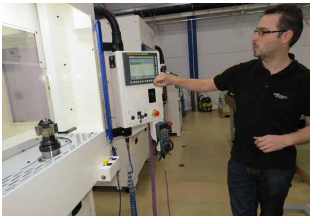
Le technicien d'application démontre l'utilité et la facilité d'accès des applications métiers graphiques développées par les ingénieurs du Groupe Recomatic sur la CNC série 31i B5 d'une machine de polissage BULA POLIGO B11.
