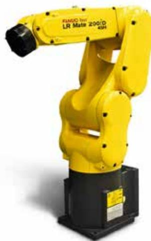
Robot polyvalent de la gamme LR Mate avec 4 kg de charge admissible.
