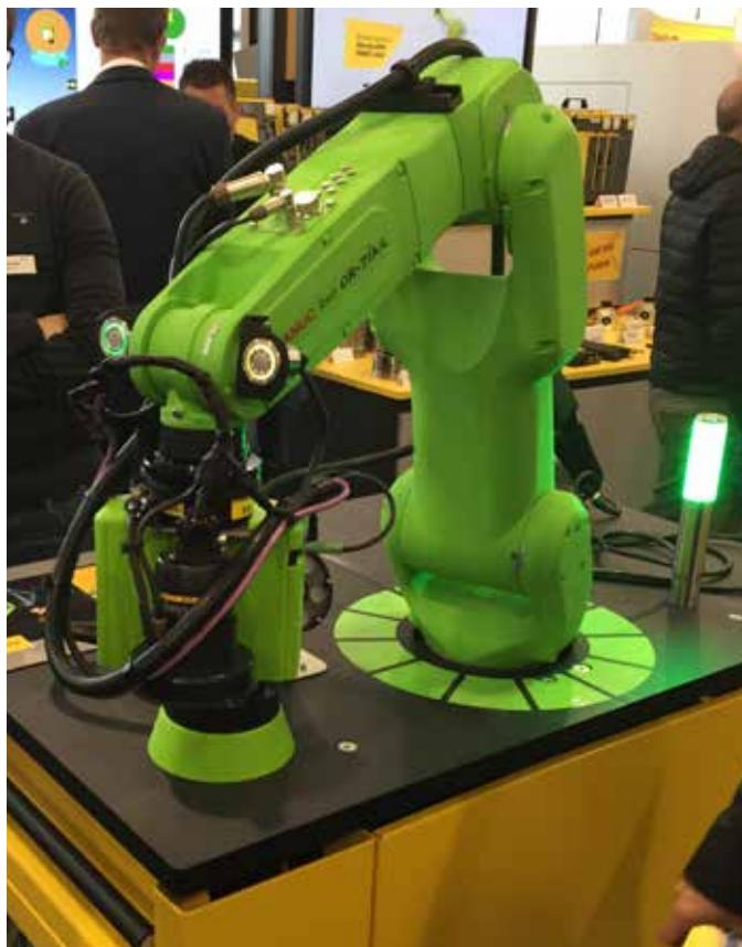
Robot collaboratif CR 7iA/L pour différents types de manipulations fastidieuses et répétitives jusqu'à 7 kilos.
