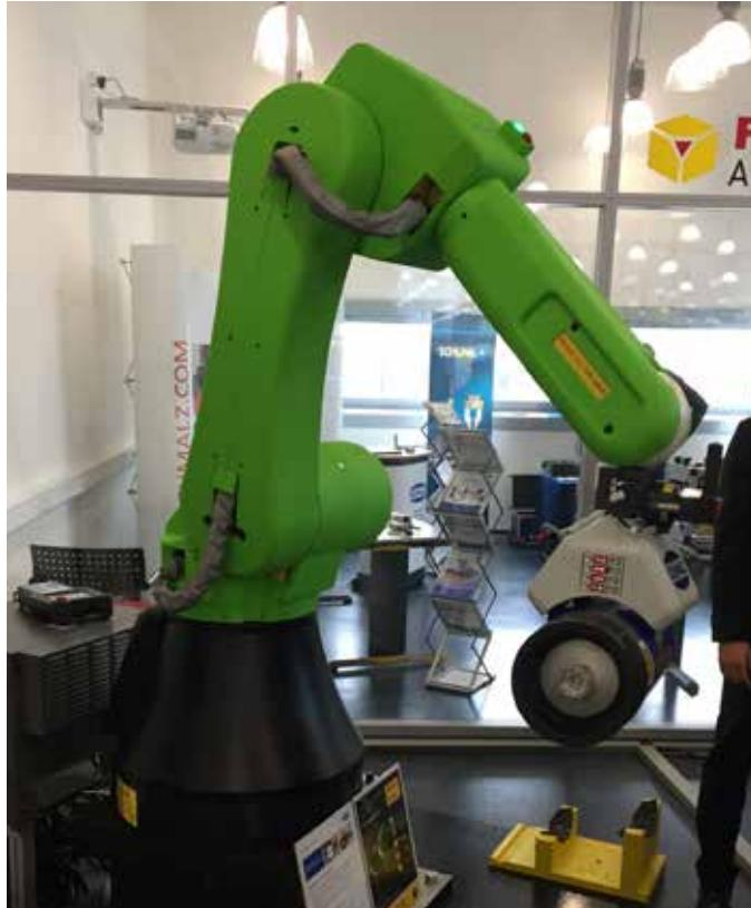
CR-35i/A, le robot collaboratif le plus puissant au monde avec une charge utile de 35 kilos.
