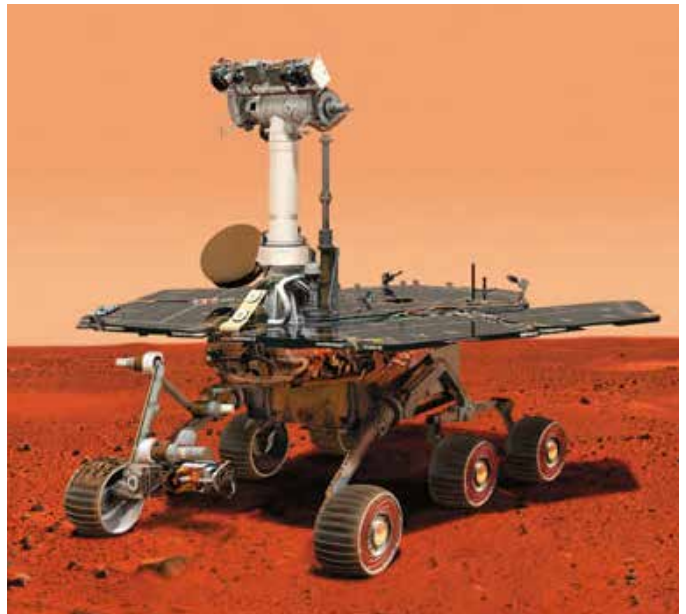
Le Mars Rover de la NASA, entraîné par 39 moteurs maxon. Der NASA Marsrover, angetrieben von 39 maxon-Antrieben. The NASA Mars Rover, drive by 39 maxon Motors.
