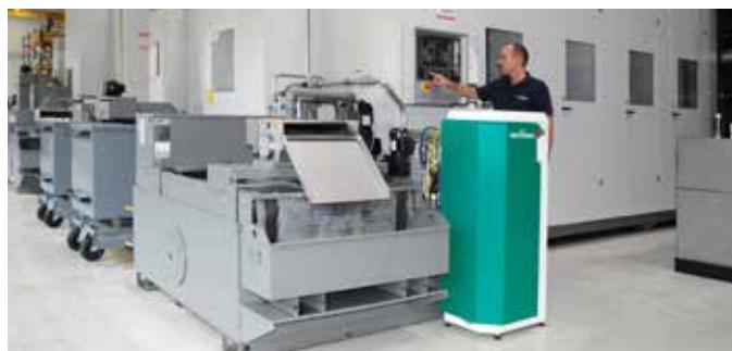
Motorex Smart Sump : sur chaque centre d'usinage, le système intelligent de gestion des fluides de production prend en charge des fonctions telles que le contrôle du remplissage autonome et de la quantité, le filtrage du lubrifiant de refroidissement, la surveillance (consommation, viscosité, degré de contamination, etc.) et la séparation de l'huile dans un bidon de 25 litres.
