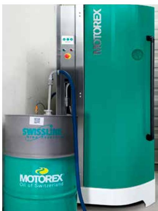
Motorex Smart Mix: Le système d'alimentation automatique en lubrifiant de refroidissement de Gressel est relié par des conduites à une cellule des centres d'usinage Starrag Heckert HEC 500. Pour ce faire, le lubrifiant réfrigérant d'une capacité de 90 litres par minute est mélangé de manière centralisée grâce à une technologie de mélange de haute précision. Le système est capable de fournir jusqu'à 100 machines-outils.
