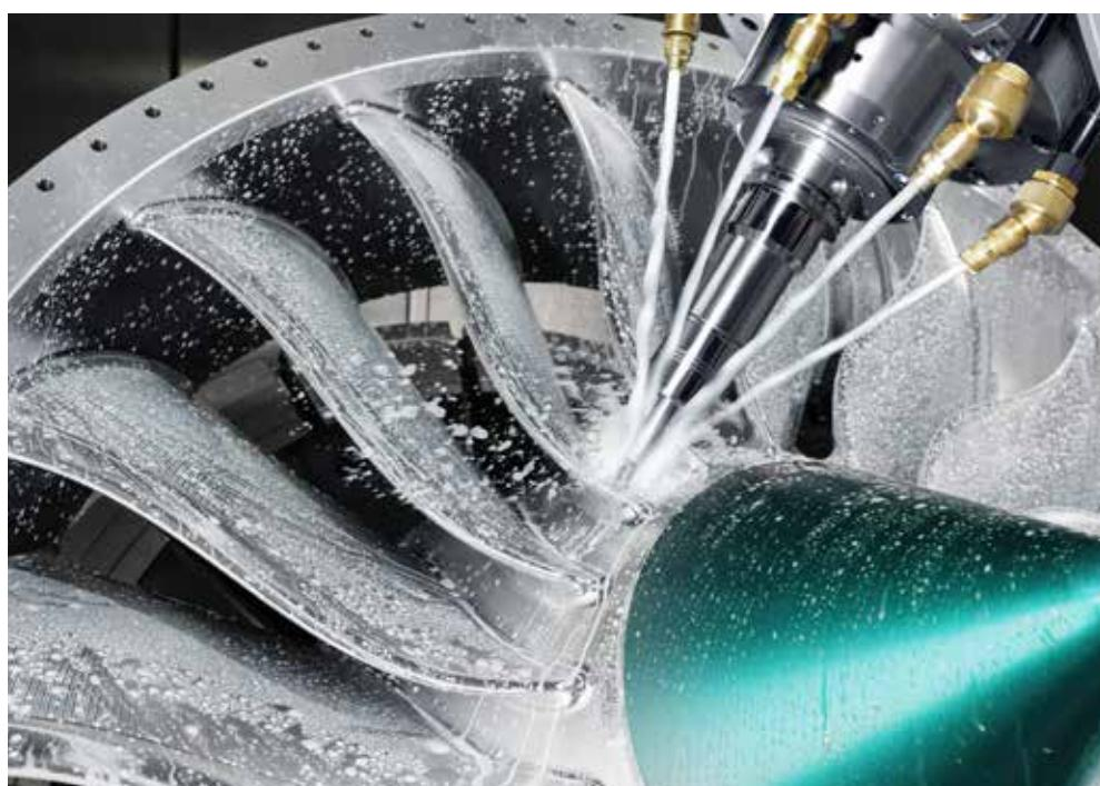
Nouvelles dimensions de performance avec Swisscool Aero 8200: usinage en toute sécurité d'une turbine d'avion en aluminium haute résistance pour l'aéronautique.
