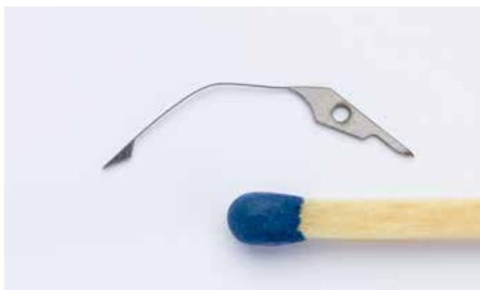
Element (Federhebel) für ein Uhrwerk, geschnitten durch Micro-Cutting AWJmm.
