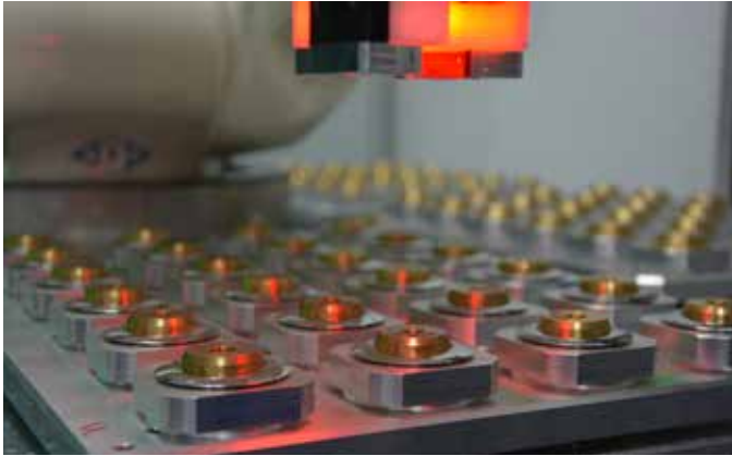
Les adaptateurs interchangeables permettent un changement rapide des pièces à usiner. (Photo : F. Rossmann)
