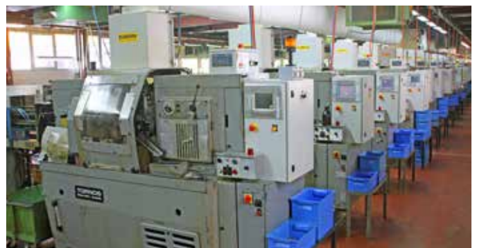
La salle des machines abrite 80 tours automatiques en formation serrée, dont 40 tours multibroches de Tornos comme ceux-ci.
