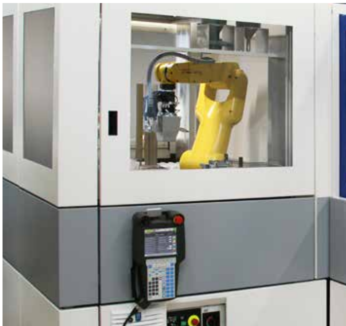
La Réco CT 501 équipée d'une cellule robotisée.
