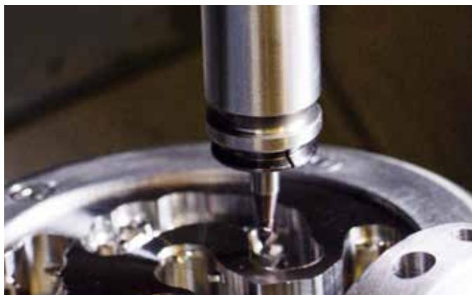
Pendant le fraisage, seuls des serrages PG-15 et des outils ayant un diamètre jusqu'à 4 mm sont utilisés.
