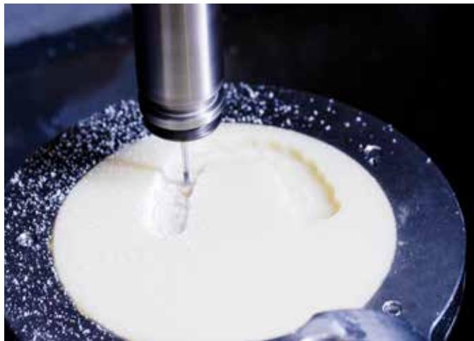
Usinage d'un disque PMMA avec powRgrip de Rego-Fix.
