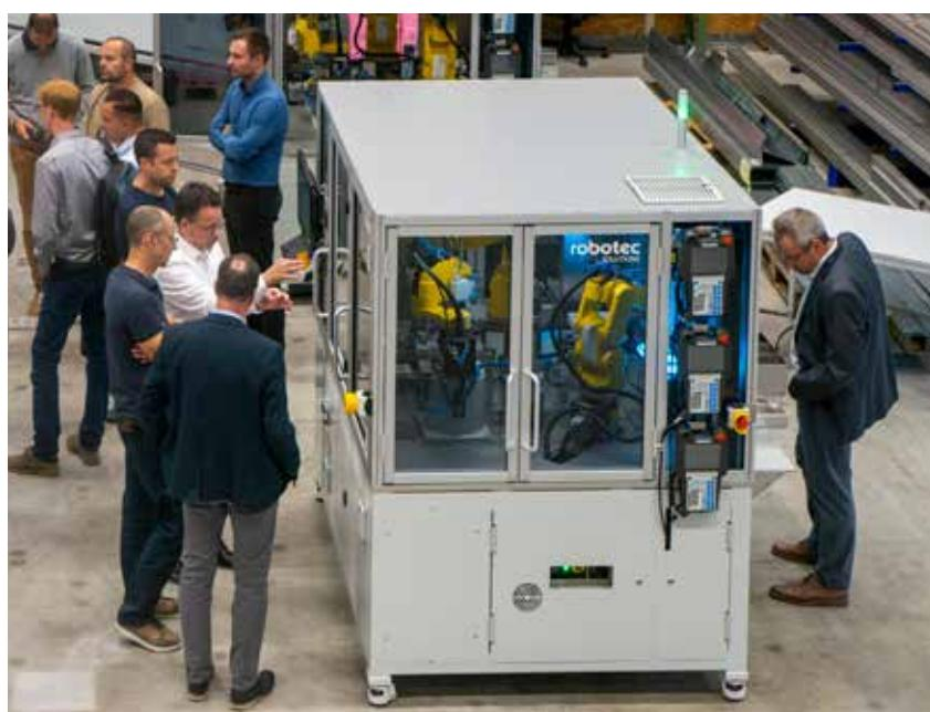
Installation très complexe munie de trois robots et neuf caméras destinée aux connecteurs électriques et qui a nécessité environ 900 heures de programmation.
