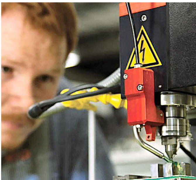
Broche rotative à haute précision avec avance et compensation d'usure automatique d'électrode.
