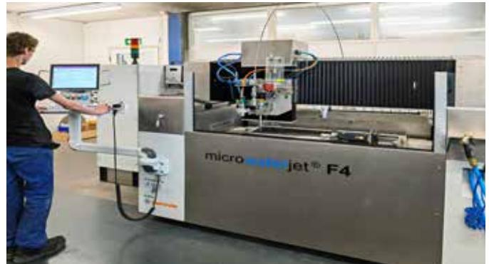
La toute nouvelle F4 du département de recherche est équipée de la dernière version de la commande et de divers accessoires tels que la broche à haute fréquence et l'axe de rotation.
