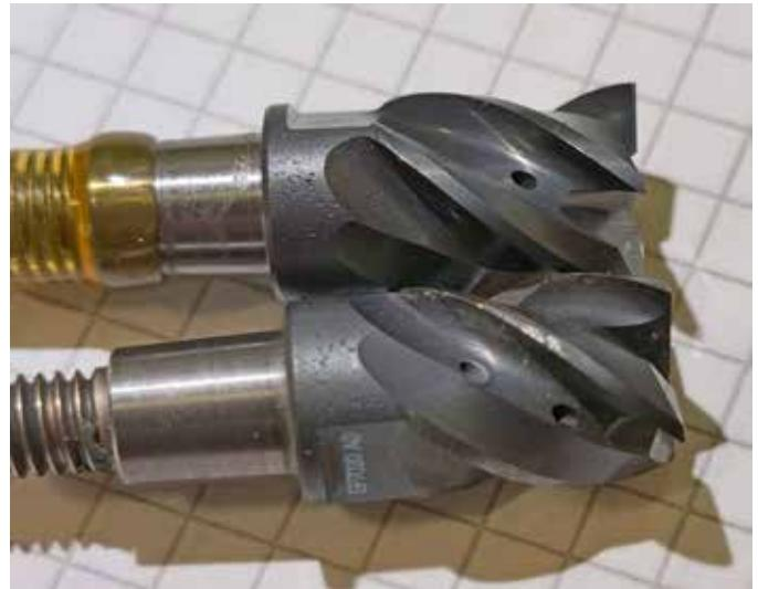
A l'aide de l'axe de rotation, des alésages supplémentaires ont été réalisés dans les rainures de serrage de la fraise inférieure jusqu'au canal intérieur du liquide de refroidissement afin d'améliorer l'évacuation des copeaux.
