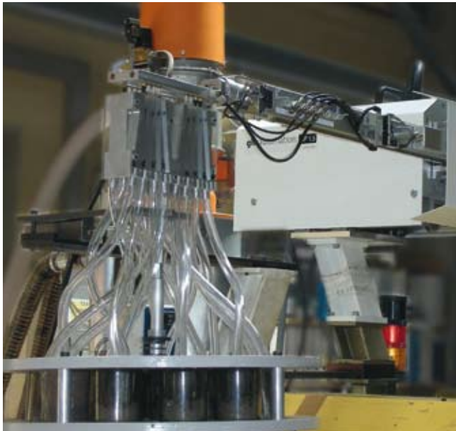
Dispositif de sorties de pièces par tri à godets permettant de suivre la production "empreinte par empreinte".
