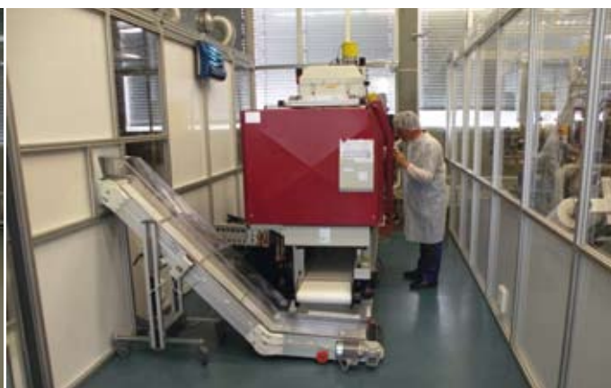
Vue d'ensemble de l'atelier d'injection. Certaines machines peuvent garantir une force de fermeture jusqu'à 240 tonnes. Gesamtansicht der Einspritzwerkstatt gewisse Maschinen können eine Schließkraft von bis zu 240 Tonnen garantieren. Overview of the injection shopfloor. Some machines can ensure a close up force up to 240 tons.
