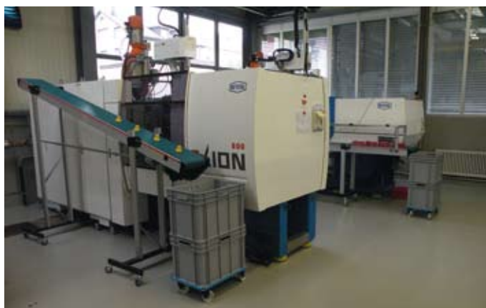
Vue d'ensemble de l'atelier d'injection. Certaines machines peuvent garantir une force de fermeture jusqu'à 240 tonnes. Gesamtansicht der Einspritzwerkstatt gewisse Maschinen können eine Schließkraft von bis zu 240 Tonnen garantieren. Overview of the injection shopfloor. Some machines can ensure a close up force up to 240 tons.
