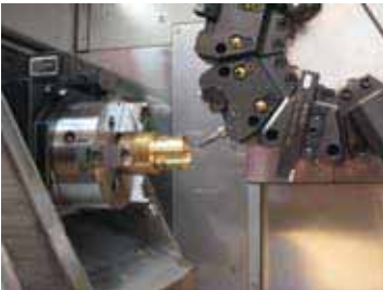
Usinage incliné grâce à l'axe A. Die A-Achse ermöglicht Schrägbearbeitungen. Inclined machining thanks to the A axis.
