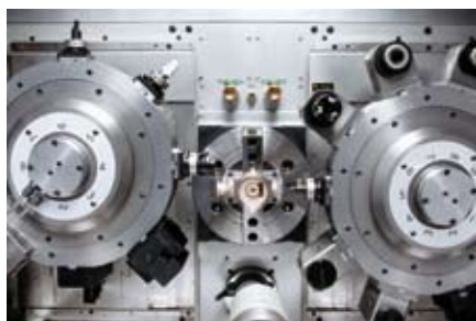
Broche avant de la S10 avec deux tourelles latérales, un entraînement d'outil, deux axes Y et une poupée mobile NC inclinable.
