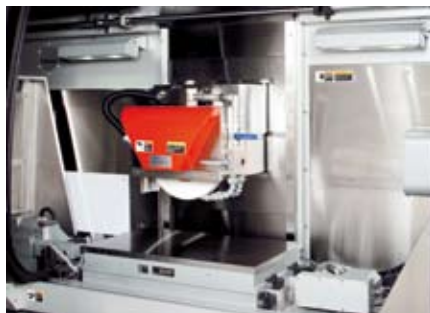
Espace de travail de la Techster 84, une machine de haute précision dans une configuration en portique très stable qui met en œuvre une technologie de dressage très novatrice.
