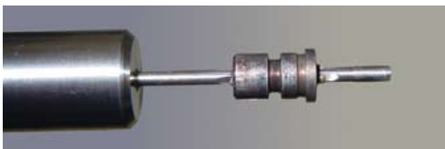
Pièce trempée positionnée sur le rodoir.
