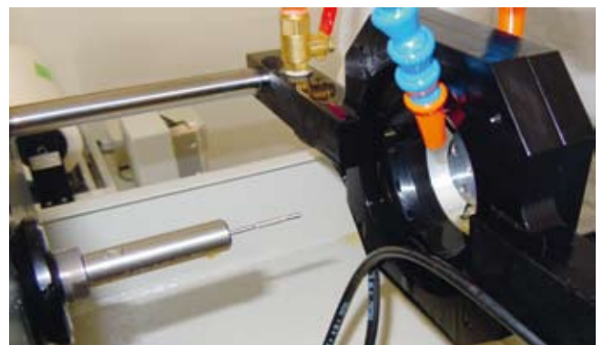
Sur la partie gauche l'outil de rodage, à droite le support de tenue de pièce.
