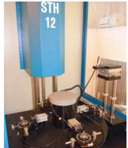
Zone d'usinage de la machine verticale STH12 de Swimatec.
