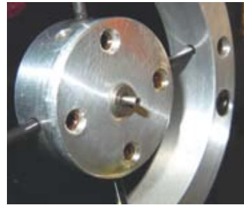
Gros plan sur le support flexible de pièce. Au centre on voit l'outil qui dépasse de la pièce à usiner. Nahaufnahme des flexiblen Werkzeugträgers. In der Mitte ist das Werkzeug zu sehen, das grösser als das zu bearbeitende Werkstück ist. Close-up on the floating gripper. In the centre we can see tool coming out of the part to be lapped.
