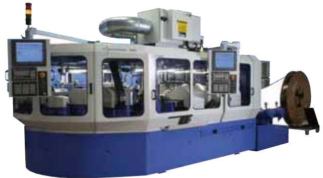
Crevoisier SA développe des machines spéciales selon cahier des charges du client. Par exemple, la C-340 dotée de 37 axes CNC pilotés par 2 commandes Fanuc 30i en parallèle. Die Crevoisier SA entwickelt Spezialmaschinen gemäss dem Pflichtenheft des Kunden, wie zum Beispiel die C-340. Diese Maschine ist mit 37 von 2 Fanuc-30i-Steuerungen parallel gesteuerten CNC-Achsen ausgerüstet.
