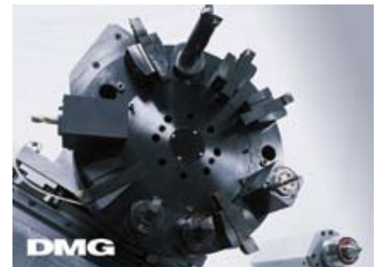
La nouvelle tourelle revolver offre douze stations. Der neue Werkzeugrevolver bietet zwölf Stationen. Te solid cast-steel bed with four guideways ensures high stability.
