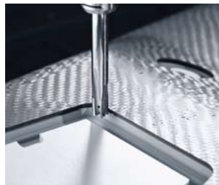
Usinage Ultrasonic de PRFC à double avance évitant l'arrachement de fibres, le délaminage et les arêtes rapportées.
