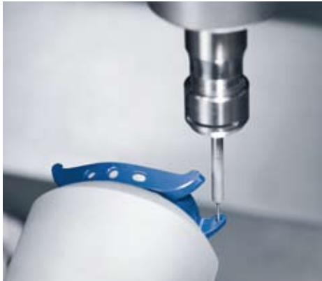
Usinage de finition d'un boîtier de montre en oxyde de zirconium bleu par meulage pendulaire avec Ra < 0,1 \mu m .
