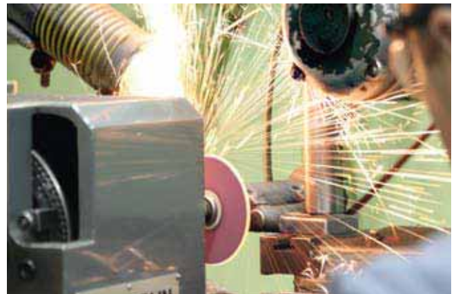
Opérations de meulage sur des pinces spéciales. Schleifarbeiten an Spezialzangen. Grinding operations on special collets.
