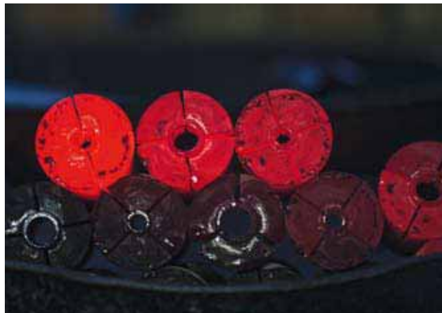
Pinces en cours de refroidissement. De très nombreux métiers sont à l'œuvre dans les ateliers de Walter Dünner SA.
