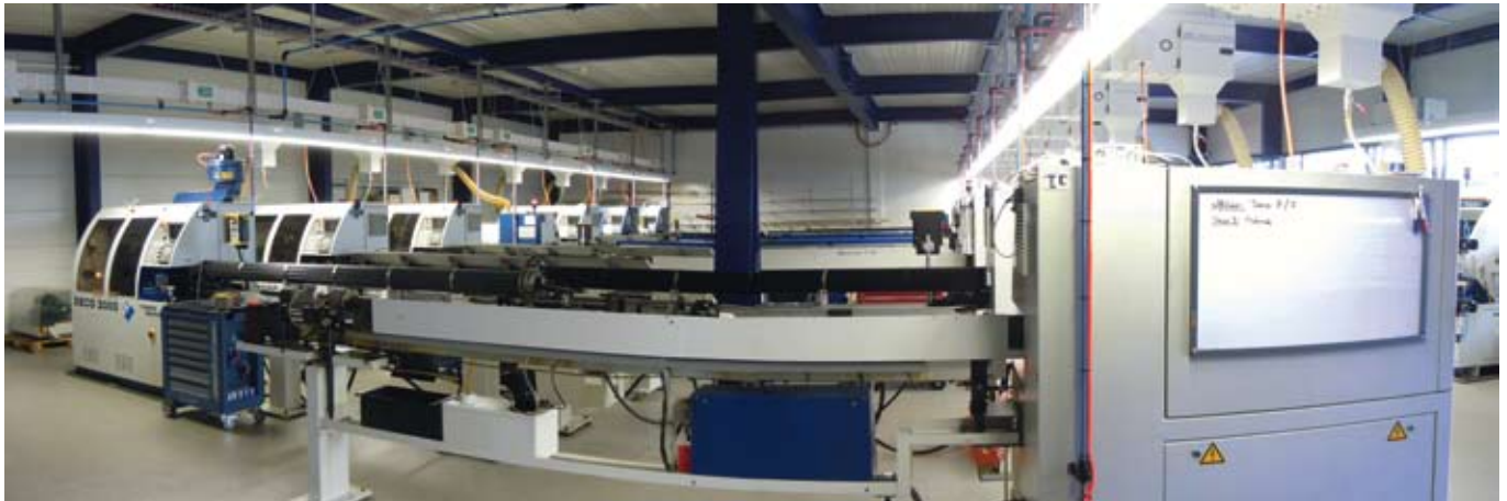
Les ateliers de easyDec sont vastes et bien éclairés, chaque machine dispose d'un système d'évacuation des brouillards d'huile avec récupération intégrée de l'huile. Die Werkstätten von easyDec sind grossräumig und gut beleuchtet, jede Maschine verfügt über ein Ölnebelabsaugsystem mit integrierter Ölaufangvorrichtung. EasyDec workshops are large and clear, each machine includes integrated oil mists evacuation with their oil recovery system.
