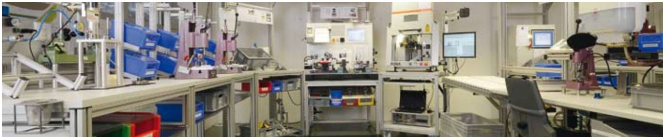
Salle de montage et d'essais; cellule de montage à flux continu en pièce à pièce - One piece flow Montage-Zelle - Installation and testing room; continuous flow mounting cell
