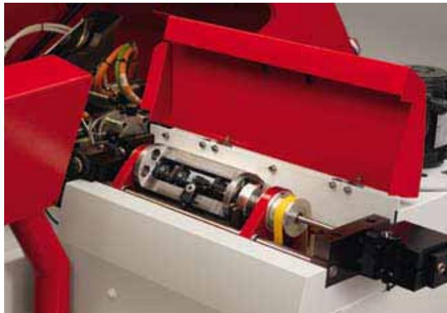
*La matière chargée dans la machine sous forme de torche est transformée en "barre" durant le passage dans le redresseur. Le redressement est réalisé par cambrage du fil durant la rotation et le recul de l'appareil de redressement, produisant ainsi une barre présentant une qualité de rectitude équivalente aux barres standards du marché.*
