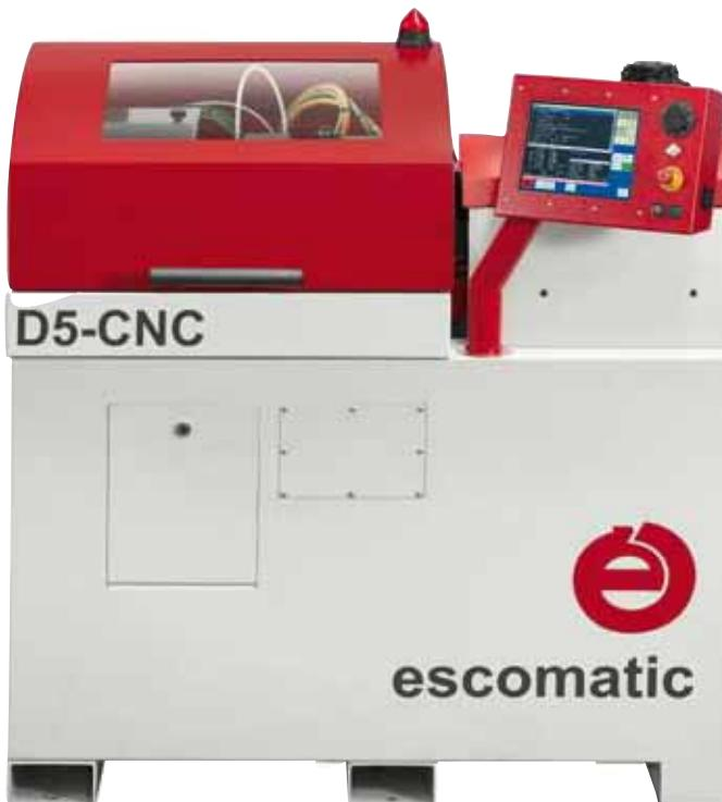
A la différence des tours conventionnels, les tours escomatic sont développés à partir d'un principe unique. La matière, alimentée sous forme de couronne ou de barre, n'a pas de mouvement de rotation. Ce sont les outils, supportés par une tête de travail rotative, qui tournent autour de cette matière, générant ainsi le mouvement d'enlèvement des copeaux.
