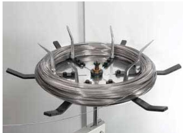
La matière est chargée dans la machine sous forme de torche. La torche, d'un poids de 30 à 50 kg est déroulée à partir d'un dévidoir intégré à la machine. La matière est tirée au travers de la machine par le système d'avance du fil.
