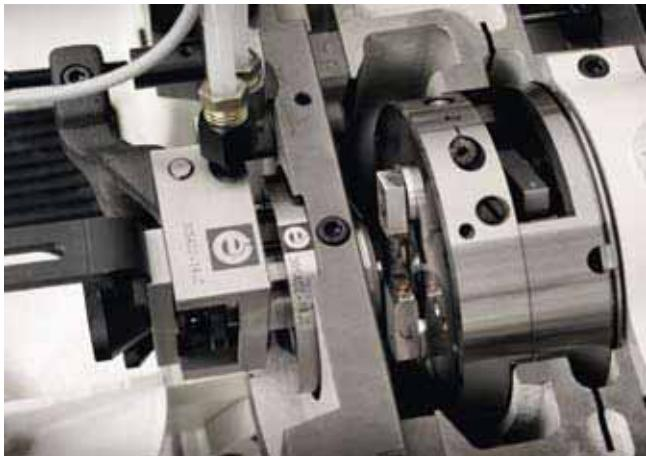
La matière étant guidée au travers d'un canon, le tournage et l'enlèvement des copeaux sont réalisés par l'application du principe unique escomatic qui fait tourner les burins autour de la matière, burins portés par une tête de travail rotative pouvant atteindre 12'000 tours par minute.
