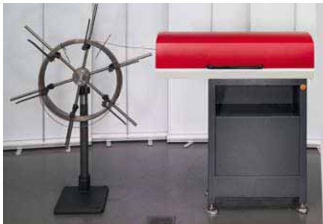
La matière peut être chargée dans la machine escomatic EC 08 sous forme de torches ou sous forme de barres. Pour le travail avec la torche, une station de redressement additionnelle est fournie.
