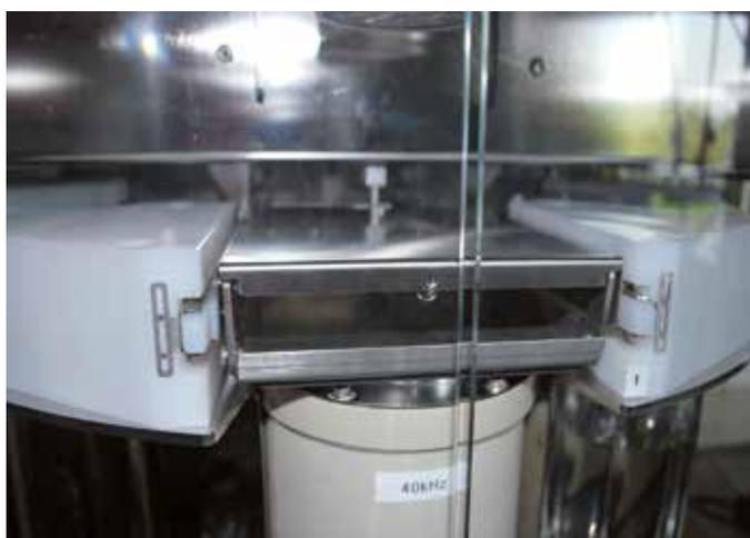
Cuve de travail totalement étanche, avec système de fermeture breveté.
