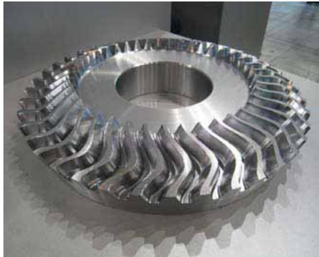
Pignon conique droit avec engrenage en cissoïde (engrenage en S) ne pouvant être produit que par fraisage.
