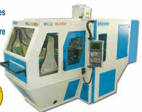
La seule machine du marché permettant l'usinage des 6 faces sur 6 barres. Machine très simple, très flexible dans le changement de production.
