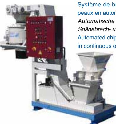
Système de broyage et d'essorage des copeaux en automatique et en continu.
