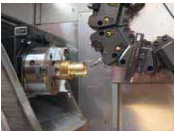
Usinage incliné grâce à l'axe A.
