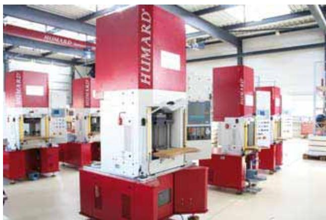
Humard Automation SA propose toute une gamme de presses hydrauliques CN/CNC de haute précision dotées de forces de 6 à 220 tonnes.
