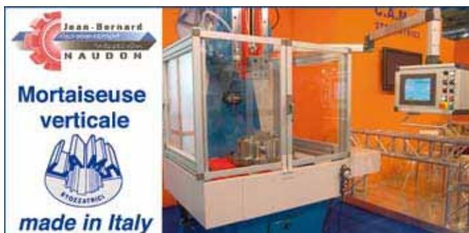
Cette machine est la seule mortaiseuse verticale du marché construite et réalisée sur les bases d'une machine-outil moderne comprenant Vis à billes + codeurs + CNC à commande simplifiée.
