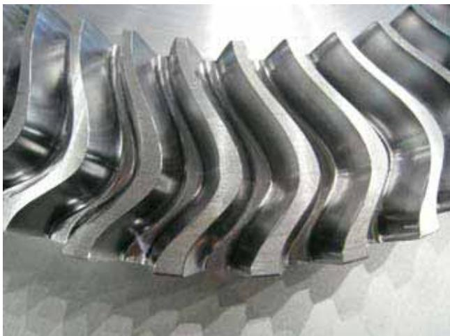
Segment d'un pignon conique droit avec engrenage en cissoïde (engrenage en S).
