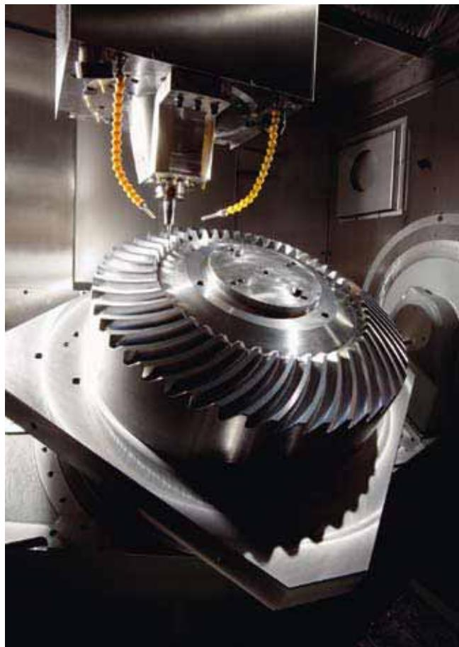
Usinage simultané à 5 axes d'un pignon conique droit de Ø 800 mm.
