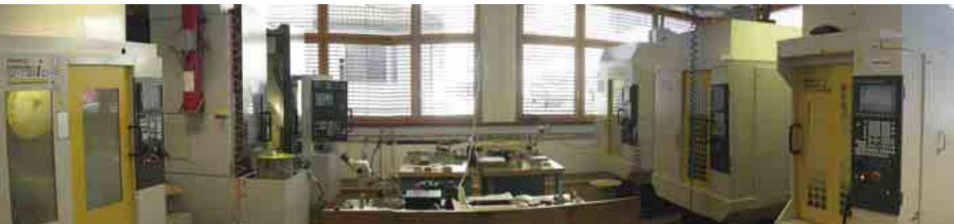
Ateliers des centres d'usinage. Le 100% des pièces prismatiques utilisées dans les micro-montages est usiné à l'interne.
