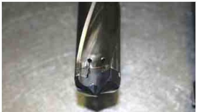
Outil de perçage Chamdrill avec son corps standard et sa tête interchangeable.
