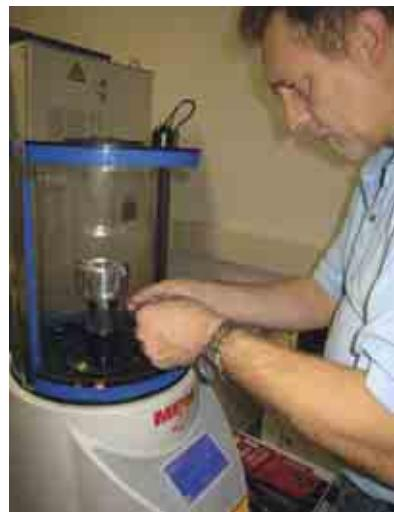
Pour l'aluminium et les composites, l'automobile et l'aéronautique sont fidèles consommateurs d'outils spéciaux PCD. Les performances exigées impliquent un soin particulier à chaque étape de fabrication, notamment pour leur équilibrage final. Cette machine et la compétence du réglleur permettent de descendre en-dessous de 0,5 gramme de défaut.
