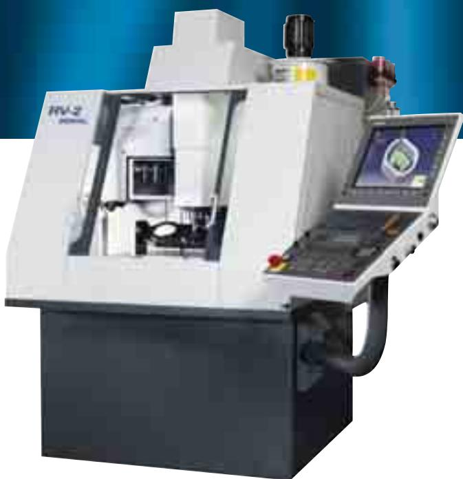
REALMÉCA, constructeur de centres d'usinages d'hyperprécision a conçu une gamme de machines spécialement destinées à la fabrication de prothèses tant dentaires que chirurgicales.
