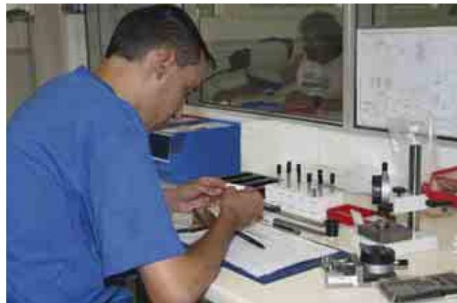
Les mesures avec des méthodes manuelles requièrent plus de temps avec un enregistrement manuel des résultats. Jean-Philippe Renaud, technicien de mesure, en train d'inspecter et de mesurer une vis pour implanter dans le genou. *Die manuellen Messungen benötigen mehr Zeit, zudem müssen die Ergebnisse von Hand aufgezeichnet werden. Der Messtechniker Jean-Philippe Renaud bei der Inspektion und Messung einer Schraube für ein Knieimplantat.*
