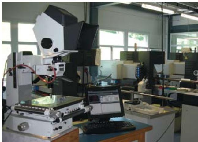
*Les contrôles de qualité des pièces en cours de production s'effectuent au sein même de l'atelier. Au premier plan un système de contrôle optique. Die Qualitätsprüfungen der im Produktionsvorgang befindlichen Teile erfolgen im Werk selbst. Im Vordergrund ist ein optisches Prüfsystem zu sehen. Parts quality control performed during production is done directly in the workshop. At the forefront an optical control system.*
