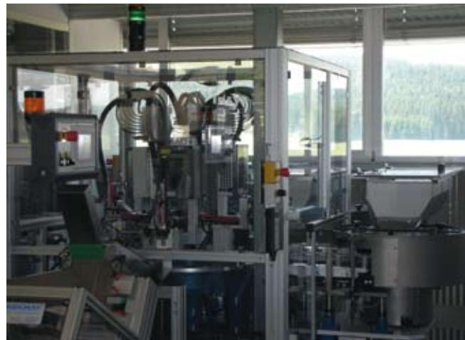
*Dispositif d'assemblage sous atmosphère protégée. Les produits sont ensuite emballés en doubles sachets afin d'être traités en salle blanche chez le client. Montagevorrichtung unter Gaschutzatmosphäre. Die Produkte werden anschließend in doppelten Beuteln verpackt, um beim Kunden im Reinraum eingesetzt zu werden.*
