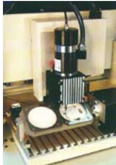
Gros plan sur l'usinage de la rondelle de zirconium sur un MIC4. Le fabricant propose également l'accès à une source d'approvisionnement en matière première à des prix calculés au plus juste.
