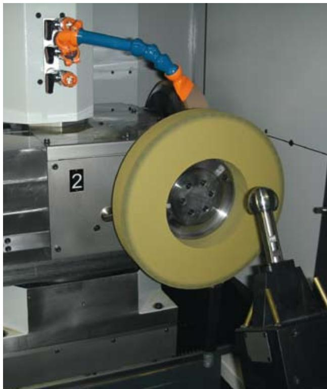
Recomatic s'implante dans le domaine médical. La finition des têtes destinées aux rotules de hanches est optimisée par une phase de rectification sur un centre 5 axes de l'entreprise.
