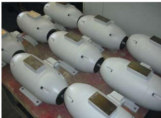
Priorité au développement pour les clients. La technologie de meulage utilisée par Recomatic générant des copeaux fins difficilement nettoyables dans les ailettes d'un moteur, un nouveau modèle lisse a été développé.
