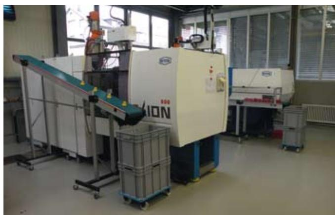
Vue d'ensemble de l'atelier d'injection. Certaines machines peuvent garantir une force de fermeture jusqu'à 240 tonnes.
