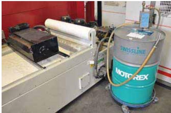
Le déshouleur à bande recueille l'huile des fuites et le filtre à bande retient les copeaux et particules métalliques les plus fins. On voit également le mélangeur à réfrigérant-lubrifiant, compact et nécessaire à tout moment, sur le fût mobile de Motorex.
