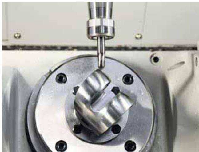
Usinage en 5 axes d'un bouclier fémoral. La finition est réalisée en 5 axes simultanés à l'aide d'une fraise boule inclinée à 45° par rapport à la surface, privilégiant ainsi une vitesse de coupe optimale. La programmation d'un tel usinage à l'aide d'Alphacam permet de constater d'éventuelles collisions.
