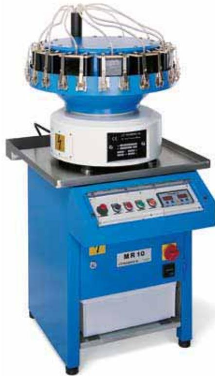
Ce vibrateur permet d'utiliser jusqu'à 10 cuves. Il est dédié à l'ébavurage et le polissage de micro-pièces de précision tels les pignons d'horlogerie par exemple.
