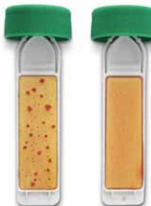
Test de colonisation bactérienne: à droite une faible colonisation (Tresor PMC®), à gauche une forte colonisation de bactéries à développement rapide (émulsion conventionnelle).
