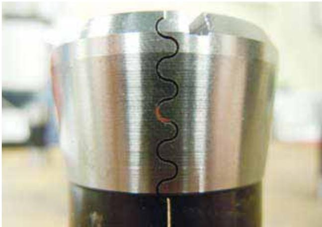
Sur cet exemple, la pince est fendue en sinusoïde selon le plan du client à l'aide d'une machine d'électroérosion à fil.
