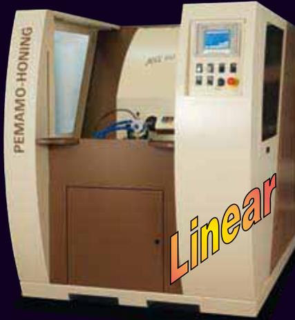
Machine de rodage de haute précision
