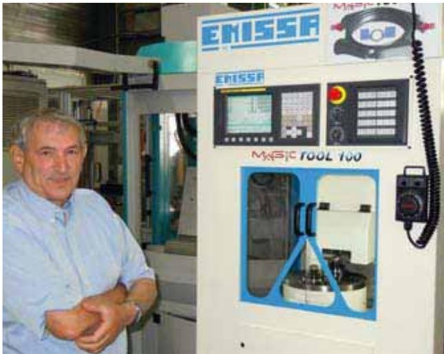
M. Boschi nous présente la Magic Tool 100. Cette machine basée sur le module Triax 100 d'Emissa permet le perçage perpendiculaire et simultané des trous de barrettes dans les carrures de montres.
