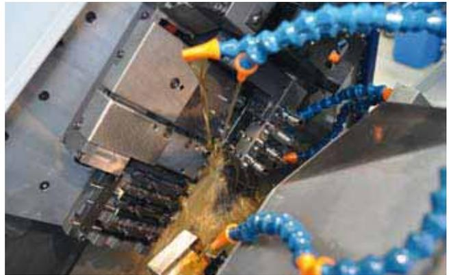
Aussi important qu'une centre d'usinage performant : le liquide de coupe utilisé a une incidence déterminante sur le processus de production et les coûts.
