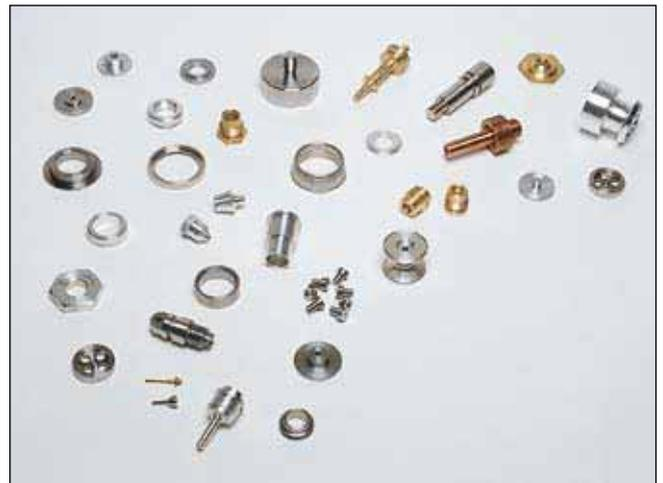
Atout flexibilité: le tour peut être utilisé soit en tournage dur, soit en tournage classique pour la réalisation de petites pièces précises.
