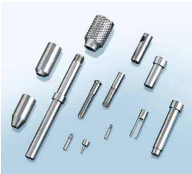
Les pinces de préhension sont constituées de nombreuses pièces tournées classiques, lesquelles sont réalisées sur des machines du type Tornos Micro 7 à partir de barres d'un diamètre de 2 à 5 mm.
