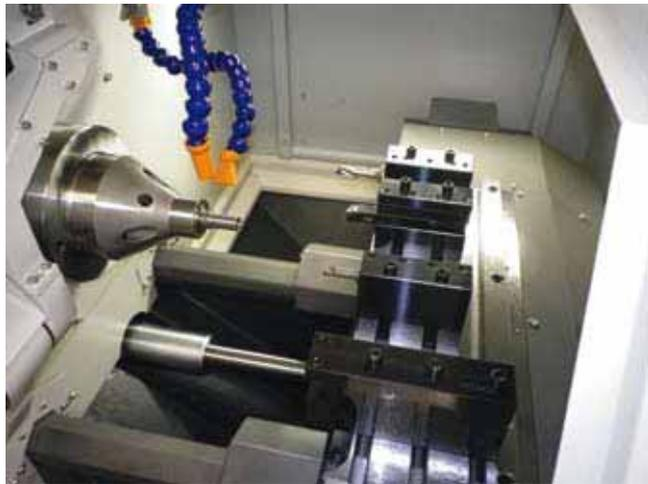
La zone d'usinage est large et aérée, l'évacuation des copeaux, toujours très chauds en tournage dur, se fait ainsi de la meilleure façon.
