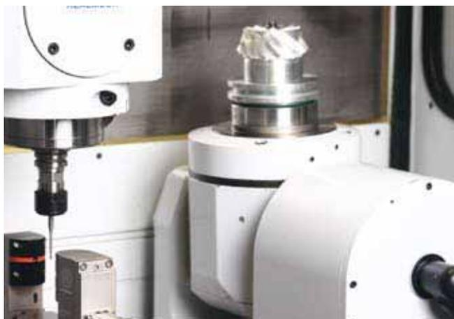
La mesure laser d'outils permet d'adapter instantanément le correcteur d'outil en diamètre et longueur, et il contrôle également l'intégrité de l'outil. Lors d'usinage avec de très petits diamètres d'outil, le contrôle laser garantit ainsi une production continue sans surveillance.
