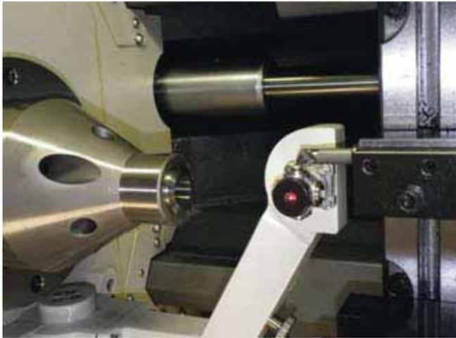
Le palpeur semi-automatique simplifie grandement la vie de l'opérateur. Les mesures sont directement intégrées à la commande numérique.
