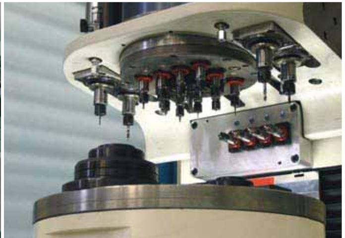
Zone d'usinage de la Speed Tool Magnum. Sur la partie gauche, les postes de chargements et d'usinage. La pièce étant serrée dans une vraie broche, il est même possible d'effectuer des opérations de tournage. A droite nous pouvons voir les 18 broches d'usinage !
