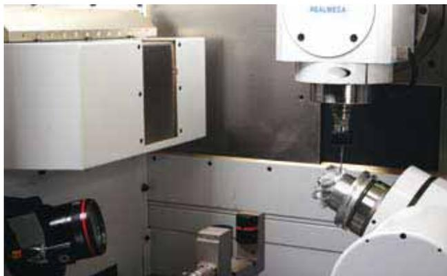
Les centres d'usinage 5 axes UGV Realmeca sont connus pour leur très grande précision et pour intégrer les systèmes de mesure en cours les plus récents. Sur cette machine, palpage, mesure laser d'outils et contrôle par caméra se conjuguent pour obtenir une précision optimale.
