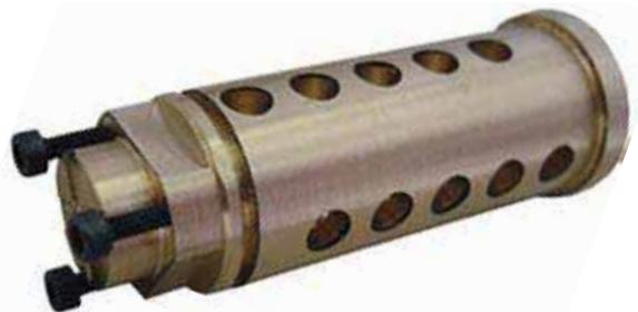
La réalisation d'une telle pièce qui nécessite 40 opérations ne prends que 50 secondes... avec trois pièces usinées simultanément, la productivité monte à moins de 17 secondes par pièce.
