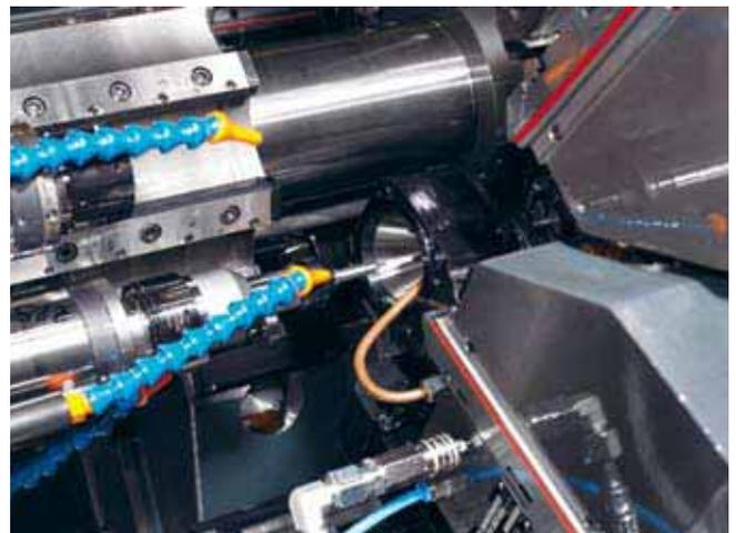
Les deux nouvelles machines sont disponibles en version « glissière centrale raccourcie ». Cette possibilité aère la zone d'usinage, permet de monter les tourbillonneurs et assure une meilleure évacuation des copeaux.
