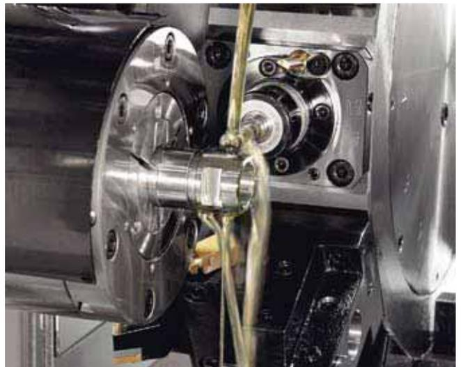
Dotée de deux tourelles largement dimensionnées et d'un axe Y sur la tourelle supérieure, la machine BNE-51SY5 autorise de très nombreuses opérations habituellement effectuées sur un centre d'usinage.
