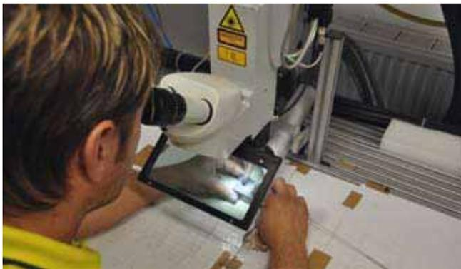
Les pièces de mâchoire de la pince de préhension sont reliées à un dispositif de traction via des éléments articulés. Ce dispositif fait l'objet d'un soudage laser sous grossissement optique.
